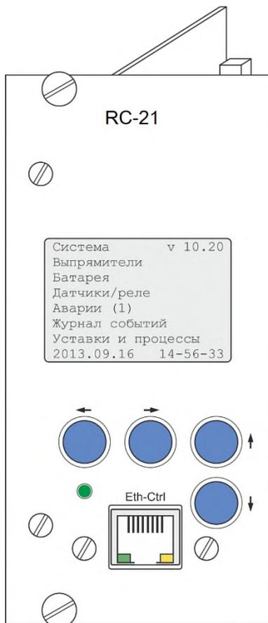
Рис.6. Вид лицевой панели модуля RC–21.
