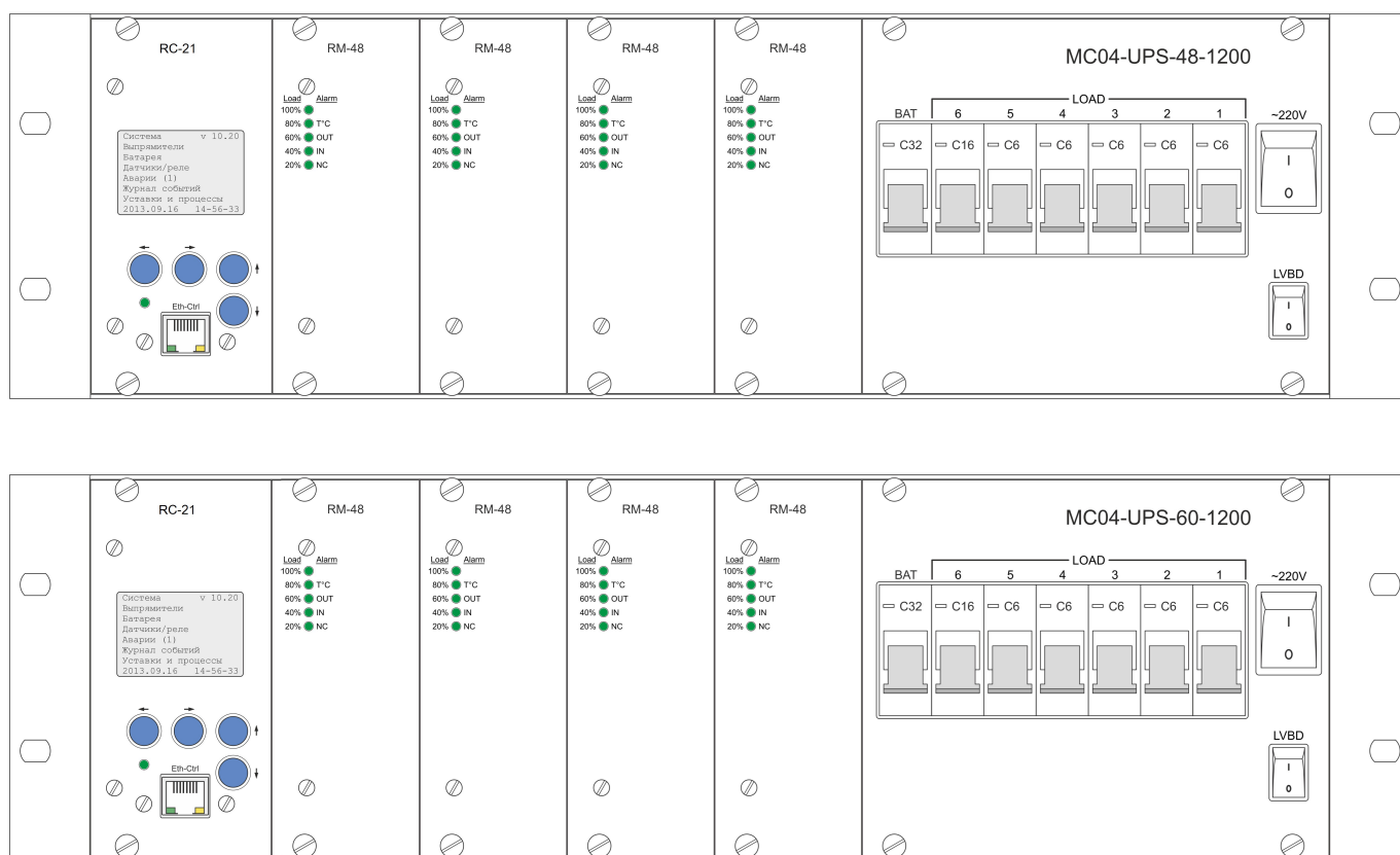
Рис.1. Лицевая сторона блоков MC04-UPS-48 и MC04-UPS-60 в полном заполнении с модулем управления RC-21.
