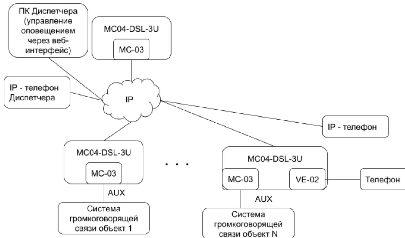
В центральной точке системы плата может служить пультом управления - диспетчер подключается с ПК к веб-интерфейсу платы, записывает голосовые сообщения в память, запускает команды на проигрывание голосовых сообщений на удалённые точки, настраивает расписание автоматического оповещения, контролирует выполнение команд.
