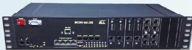
Мультиплексор **MC04-dsl.GE** предназначен для передачи потоков E1, аналоговых телефонных стыков и данных Ethernet 10/100/1000Base-T по волоконно-оптическим кабелям со скоростью 1,25 Гбит/с.
