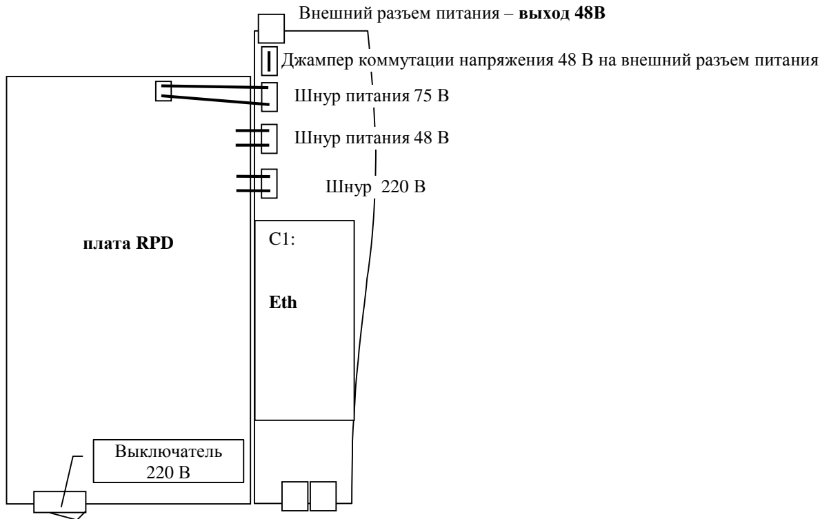
Рис. 4б. Схема расположения узлов модем-мультиплексора MC04-DSL.F-xxx-220V.
