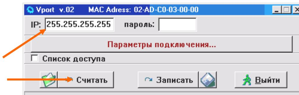
Рис. 4.2. Определение IP-адреса модуля.
