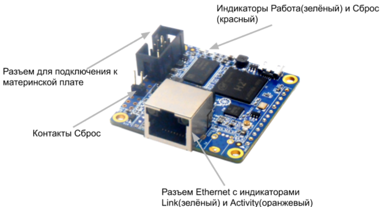
Рис 1.1 Внешний вид модуля S-port
