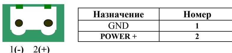
Рис. 2.4.1. Разъем подключения питания (вид на терминал)
