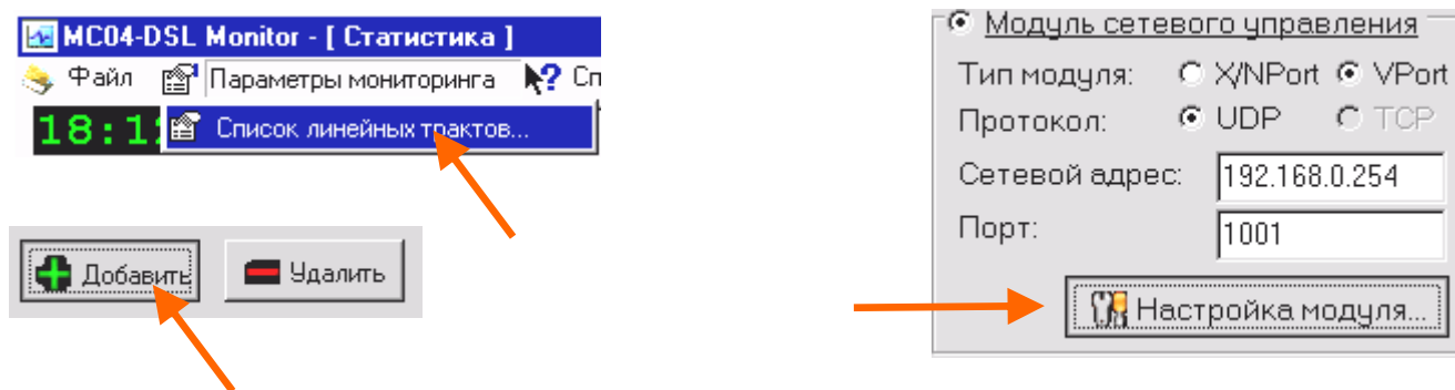
Рис. 3.5. Вызов окна конфигурации модуля Vport из программы Monitor .
