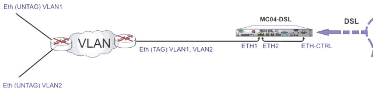
Рис. 2.3. Использование модуля Vport для мониторинга в сетях VLAN.
