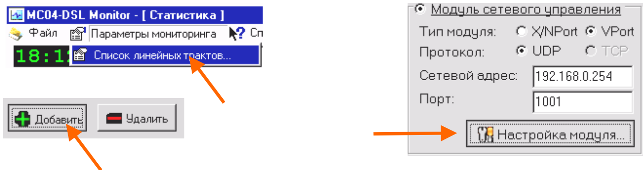
Рис. 3.5. Вызов окна конфигурации модуля Vport из программы Monitor .
