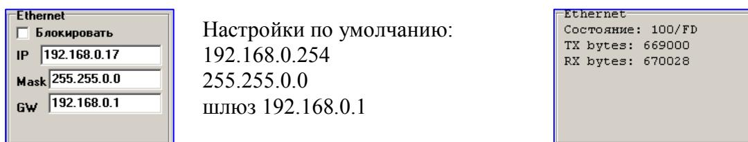
Рис.6. Настройки порта и отображение состояния
