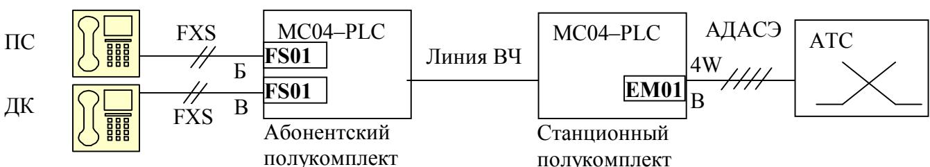
На абонентском полукомплекте установлены два модуля FS01 в порты Б и В, которые обеспечивают интерфейсы FXS для подключения телефонных аппаратов соответственно абонента ПС и диспетчера ДК.
