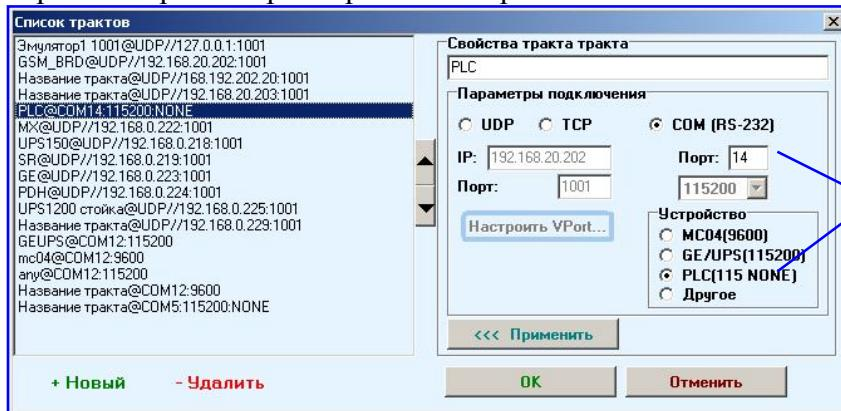
Выбрать номер порта и тип устройства PLC (115/NONE).
