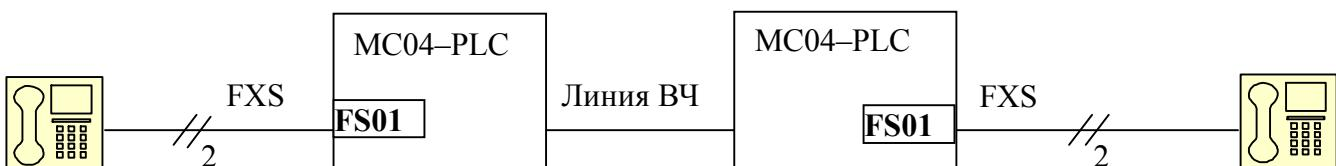
Обеспечивается прямое соединение между двумя телефонными аппаратами. При снятии трубки на телефонном аппарате одной стороны телефон на другом конце будет прерывисто звонить: 1 с – звонок, 4 с – пауза. Пока трубка на другом конце не снята, на поднятый телефон проходит акустический сигнал контроля посылки вызова (**КПВ**). При отсутствии связи между полукомплектами выдается сигнал **Занято**.
