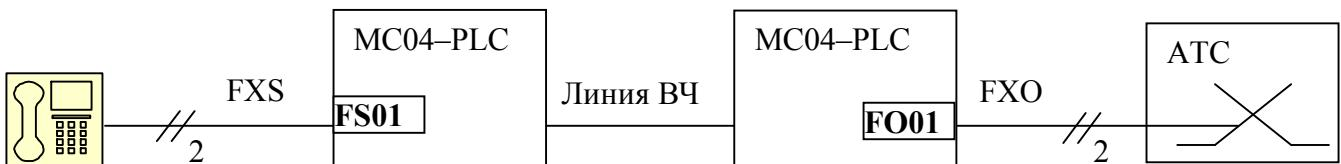
ТЧ канал аппаратуры помещается в разрыв 2-х проводного шлейфа между телефоном и абонентским комплектом АТС. Поддерживаются как тональный DTMF, так и импульсный набор номера. Занятие линии, вызывной сигнал, импульсный набор номера передаются на другую сторону вне полосы ТЧ по выделенному в ЦП каналу сигнализации.
