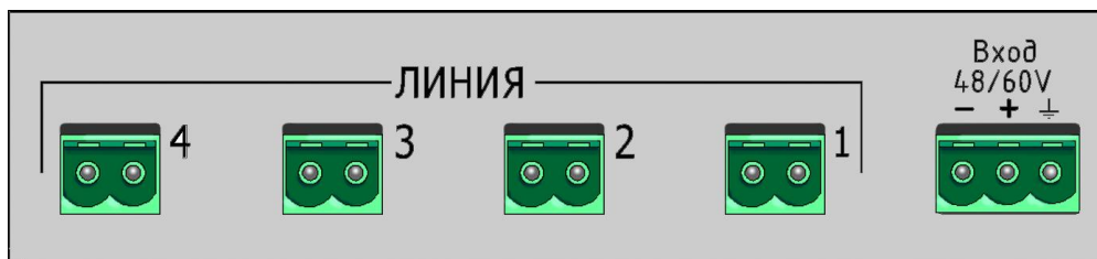
Рис. 3. Задняя панель блока МС04–ТА57.
