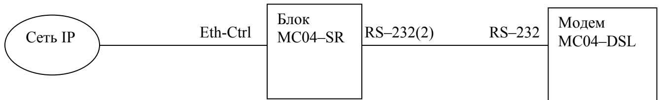
Рис. 5.2. Схема включения MC04–SR в качестве конвертора RS–232 в Ethernet.
