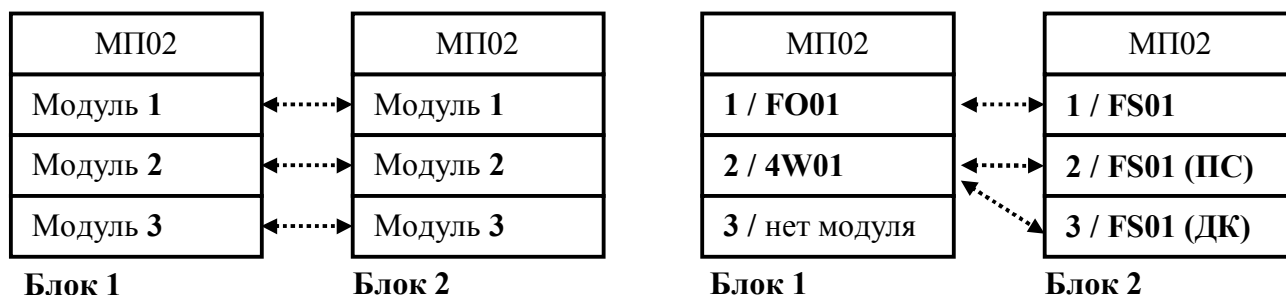
Рис.4. Схема установки голосовых модулей ТЧ.
