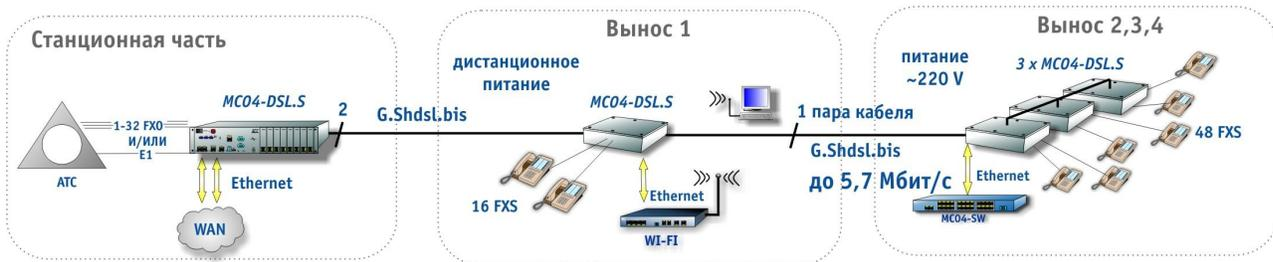
Рис. 2. Организация связи по одной паре с функцией транзита на промежуточных абонентских блоках.
