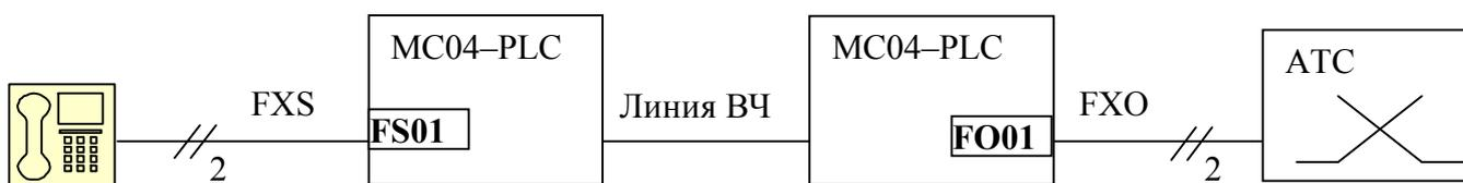
ТЧ канал аппаратуры помещается в разрыв 2-х проводного шлейфа между телефоном и абонентским комплектом АТС. Поддерживаются как тональный DTMF, так и импульсный набор номера. Занятие линии, вызывной сигнал, импульсный набор номера передаются на другую сторону вне полосы ТЧ по выделенному в ЦП каналу сигнализации.
