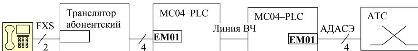
Абонент соединяется с АТС через 4-х проводный ТЧ канал, организованный с помощью модулей EM01. Подключение 2-х проводного телефона к 4-х проводному каналу обеспечивается абонентским транслятором, например типа АОТ12-ДК, который абонентскую сигнализацию FXS преобразует в сигнализацию АДАСЭ. Сигналы АДАСЭ – частотные сигнальные посылки 1200/1600 Гц – передаются без обработки прозрачно внутри полосы по ТЧ каналу.
