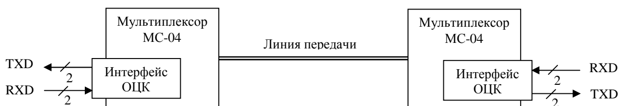
Рис. 1. Схема организации передачи данных по интерфейсам ОЦК.
